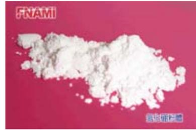
福納米公司提供之表面改質六方氮化硼粉體，具有好分散、吸油性低等特點，使製備產品時效率、效能提高，更易調製成高導熱、散熱絕緣導熱膏、絕緣導熱膠及絕緣散熱漆等導熱塗料或耐高溫潤滑、離型脫膜產品；目前提供此 mBN(Modified Boron Nitride)系列產品有:mBN-010-J1(D<sub>50</sub> <3 μm)、:mBN-050-J1(D<sub>50</sub> 約 5 μm)、:mBN-080-J1(D<sub>50</sub> 約 8 μm)等三種粒徑規格，是用高溫合成，純度高，物性穩定且比重輕之合成體，再經噴氣粉碎之氮化硼粉體，然後經提純及自行研製之高溫噴霧表面處理技術處理而成，不但各項電子特性檢測，都能達到預期標準，且導熱絕緣特性易於展現，故性價比相當突出，其規格如下：
