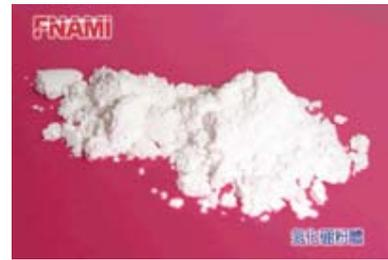
絕緣高導熱陶瓷導熱材料中以六方氮化硼所含金屬含量最低，此乃合成原料不含金屬成分，在合成後之研磨加工因質地軟，產生金屬磨耗汙染的機會大幅降低之故，但傳統各種球磨或錘擊式研磨設備總有零組件更換的時候，在剛更換初期常因零組件表面微粗燥或拋光殘留金屬粉塵，導致這段期間含鐵等金屬成份稍高，電氣特性受影響；為克服此問題，福納米公司之六方氮化硼粉體在 2014 年 6 月起，已全面採用先進噴射粉碎系統(JetMill) 研磨，並在台灣用日本 HORIBA, EMIA-920V2、日本 HORIBA, EMGA-930、美國 Thermo, X-ray 等分析儀器檢測，氧、碳、鐵 等含量都在標準以下，且純度較容易確保長期規格一致，致電氣特性較易保持穩定及一致性，有利於高精密電氣特性要求之產品的開發推展。
