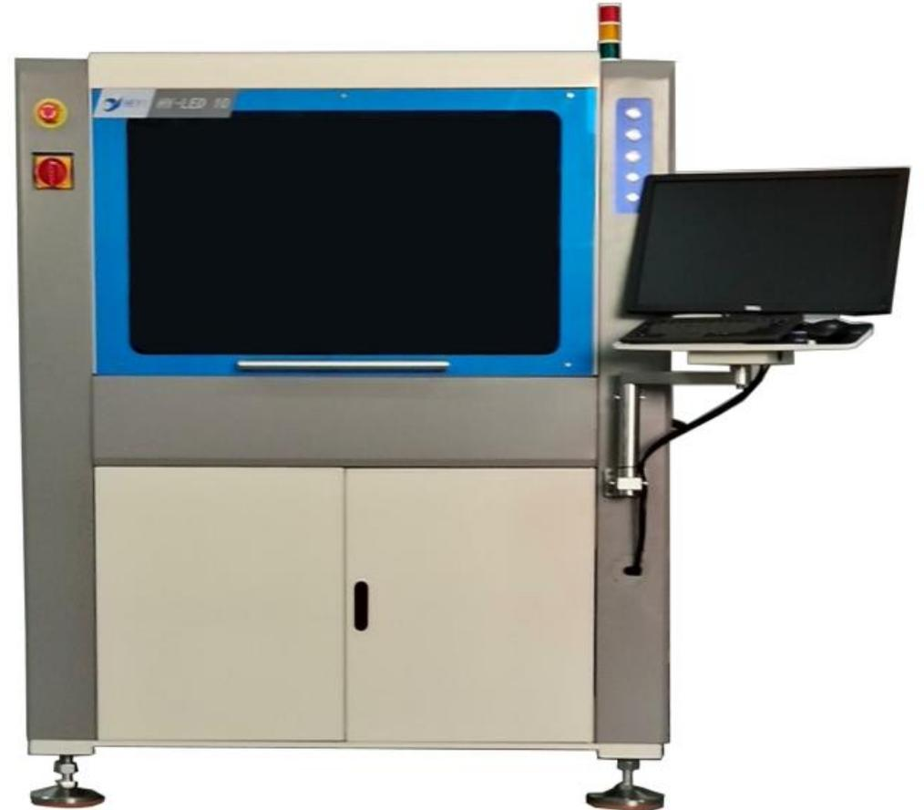
三合一（去晶+補晶+焊晶）
