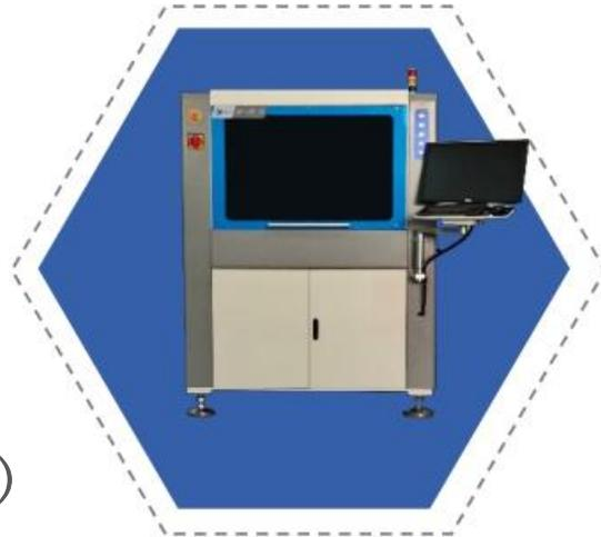
三合一（去晶+補晶+焊晶）
